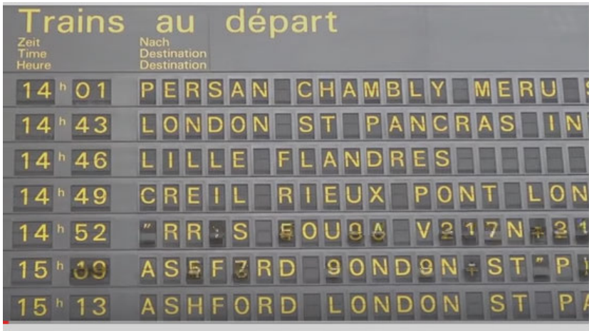
FIGURE 3 – Panneau d'affichage à palettes mécaniques d'une gare ferroviaire.
